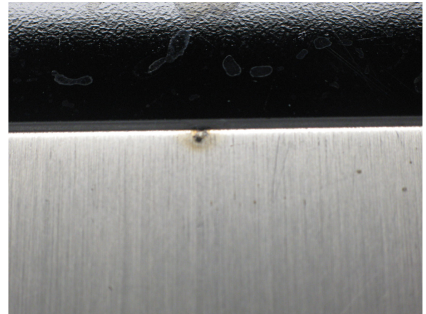
Abb. 1-6: Bild links: Verschweissung zweier sich berührender Chromstahlwannen (mittlere Heizstufe); Bild rechts: typischer Schweisspunkt beim Übergang vom Kochfeldeinsatz zum Chromstahltisch
