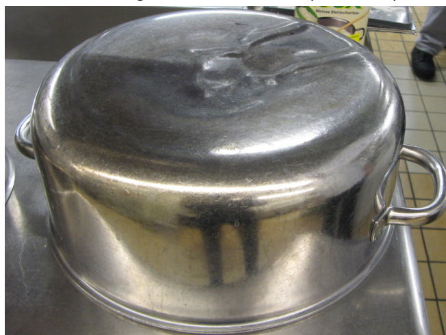
Abb. 5-3: «Alte Pfanne» mit defektem gewölbtem Boden (die Pfanne wurde irrtümlich auf Kochfeld stehen gelassen)
